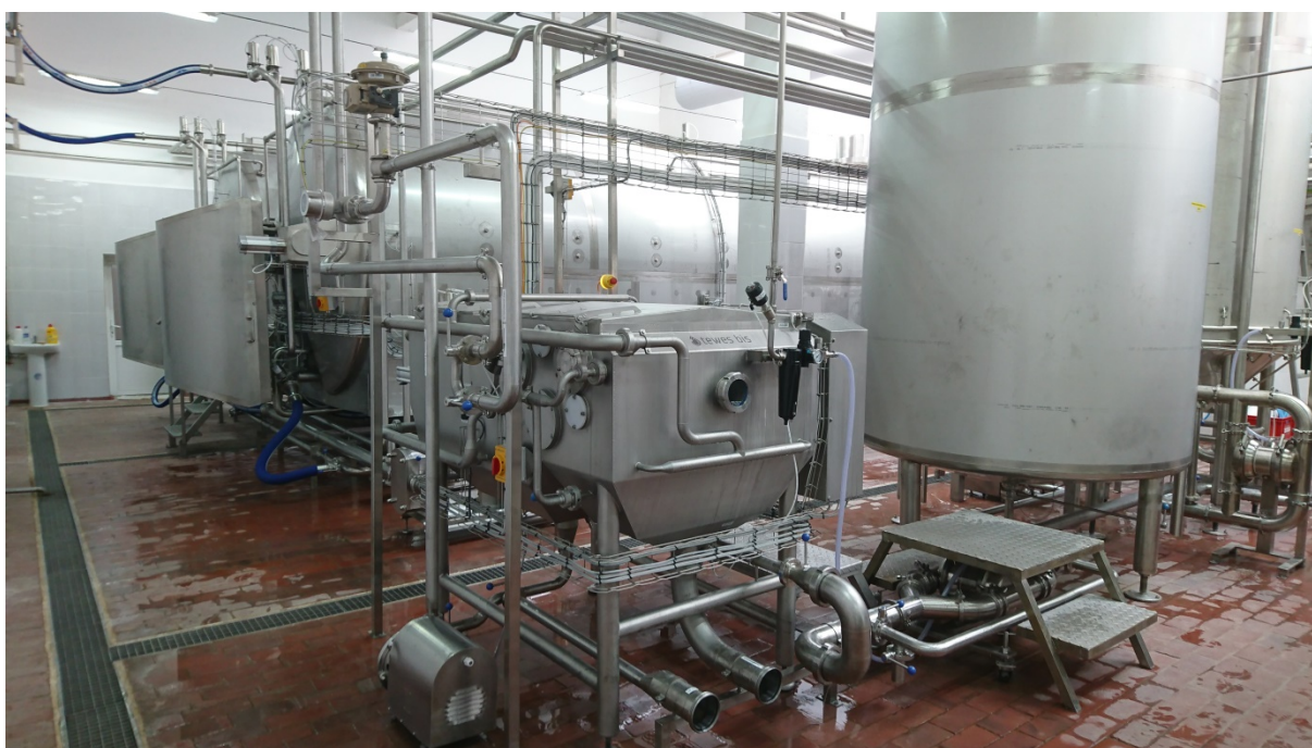
Отделитель сыворотки от творожного зерна на фоне горизонтальных котлов и буферной емкости для воды
