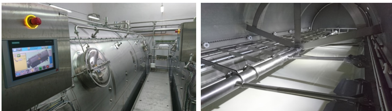
Коагуляционный котел горизонтальный с системой управления технологическим процессом
