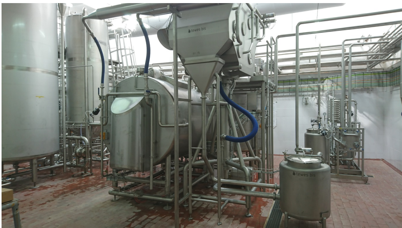
Осушитель творожного зерна с горизонтальным смесителем типа «creamer»
