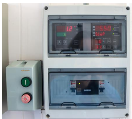
Аппарат для онлайн мониторинга процесса коагуляции молока
