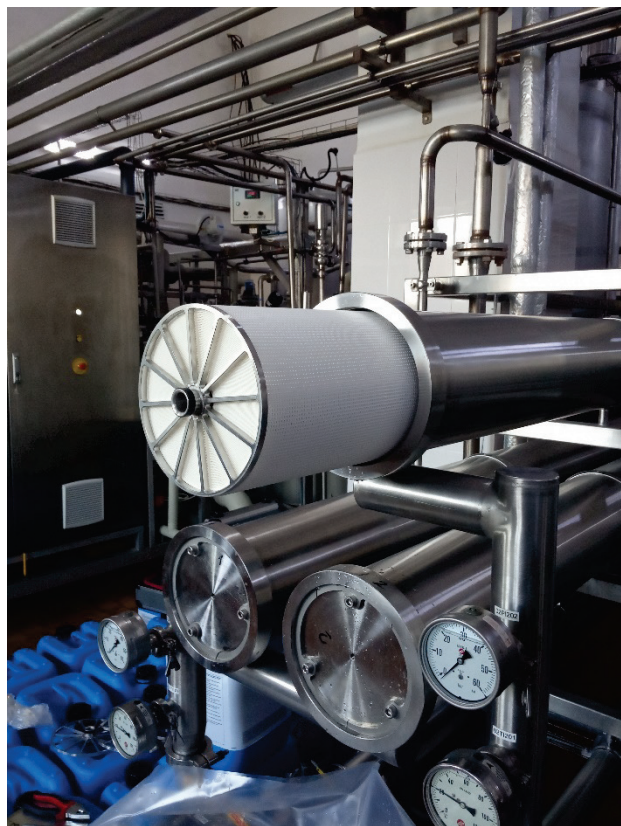
Рисунок 1. Санитарный мембранный элемент SNNF 8038-31 для сгущения сыворожки
