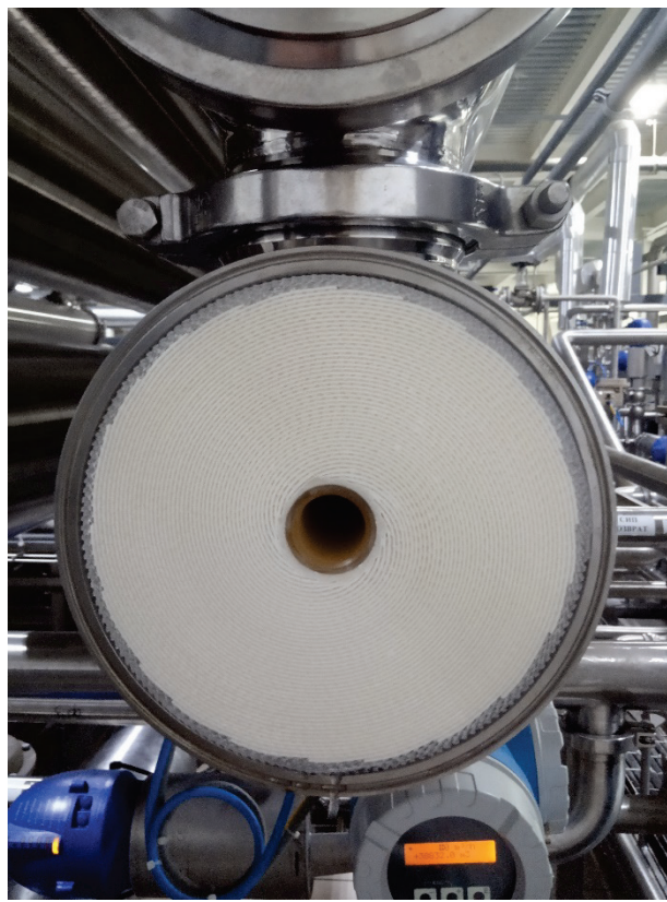
Рисунок 2. Санитарный мембранный элемент SNUF 8038-10-46 PP для концентрирования белка
